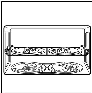
Pour chauffer deux assiettes côte à côte au bas du four, ou bien une assiette plus grande, il ne faut pas que le plateau tournant tourne. Arrêter le plateau tournant en appuyant sur TURNTABLE ON/OFF (Plateau tournant marche/arrêt). Le message "TURNTABLE OFF" apparaît sur l'afficheur. APPUYER pour entrer le réglage.
