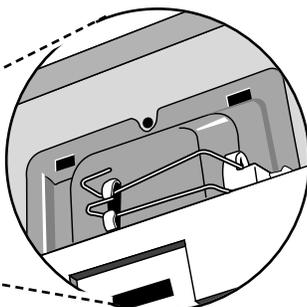
5. Enlever l'ampoule grillée en pinçant les agrafes métalliques et tirer vers la droite et soulever. Installer une ampoule halogène de basse tension de 10 W (N° de pièce 8169418). Utiliser un linge doux pour manipuler les ampoules, ou porter un gant de coton. Ne pas toucher les ampoules avec les doigts nus.
