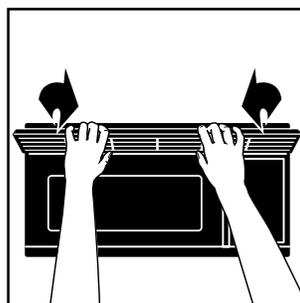
7. Insérer le sommet de la grille d'évent dans son logement. Pousser par-dessous pour exécuter l'emboîtement. Réinstaller les vis de montage.
