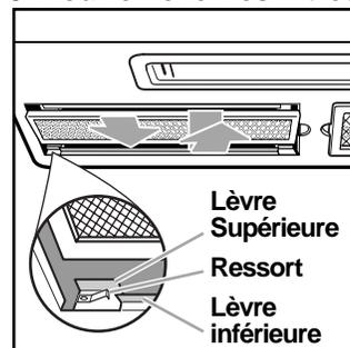
4. **Faire tremper les filtres à graisse dans de l'eau chaude et un détergent doux.** Frotter et l'agiter dans l'eau pour éliminer la saleté et la graisse incrustées. Bien rincer, et secouer. **Ne pas utiliser d'ammoniaque, d'agents de nettoyage**
