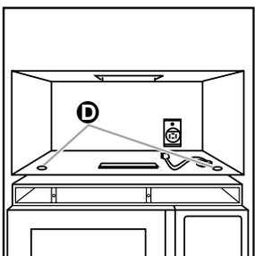
3. Après avoir enlevé tout le contenu du four, y compris le plateau tournant et le support, fermer la porte et la fixer au moyen de ruban adhésif. Ensuite retirer les deux boulons **D** servant à fixer le four à
