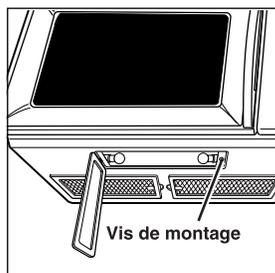
3. Enlever l'ampoule grillée; installer une ampoule halogène de basse tension 10 W (N° de pièce 8169418). Utiliser un linge doux pour manipuler les ampoules, ou porter un gant de coton. Ne pas toucher les ampoules avec les doigts nus.
