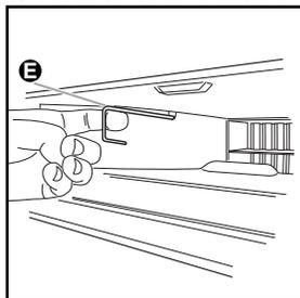
insérer dans une ouverture de la grille un mince fil de fer plié en deux ou tout autre outil semblable pour pouvoir tirer sur le crochet.
