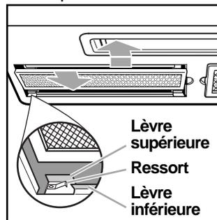
6. **Pour réinstaller les filtres à graisse**, slide each filter faire glisser chaque filtre dans le côté extérieur de l'ouverture du filtre. S'assurer que vous glissez le côté du filtre qui n'a pas de languette. Tenir la languette avec l'autre main. Pousser le côté de la languette du filtre et le glisser de l'autre côté de l'ouverture pour le fixer en position.
